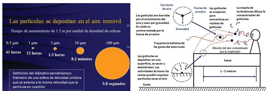
Figura 1 (a) muestra el tiempo de asentamiento de las partículas en 1,5 m (5 pies) que se asientan en el aire en reposo. La figura 1b ilustra la aerobiología teórica de la transmisión de gotículas y partículas en pequeños aerosoles producidas por un paciente infectado con una infección aguda.
